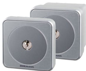
Contacteurs à clé STUP 50 / STAP 50 Version encastrée et apparente, 3 clés incluses, fonction impulsion ou OUVERTURE-FERMETURE au choix ; boîtier en zinc moulé sous pression en aluminium blanc RAL 9006 avec cache en acier inoxydable, indice de protection : IP 54 (ill. de gauche à droite)
