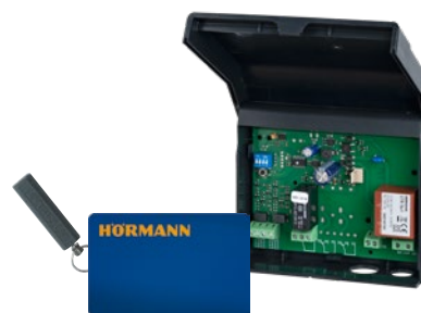
Clavier transpondeur TTR 1000-1 Pour 1 fonction, par clé transpondeur ou carte transpondeur, jusqu'à 1000 clés ou cartes mémorisables Dimensions : 80 x 80 x 15 mm (L x H x P) ; Boîtier décodeur : 140 x 130 x 50 mm (L x H x P) Puissance de commutation : 2,5 A / 30 V CC ; 500 W / 250 V CA
