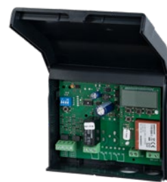
Boîtier décodeur Pour claviers à code CTR 1b-1, CTR 3b-1, CTV 3-1 et CTP 3 Dimensions : 140 x 130 x 50 mm (L x H x P) Puissance de commutation : 2,5 A / 30 V CC 500 W / 250 V CA
