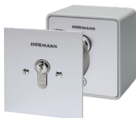
Contacteur à clé ESU 30 / ESA 30 Version encastrée et apparente, 3 clés incluses, fonction impulsion ou OUVERTURE-FERMETURE au choix ; boîtier en zinc moulé sous pression gris clair RAL 7040 avec cache en acier inoxydable ; indice de protection : IP 54 (ill. de gauche à droite)
