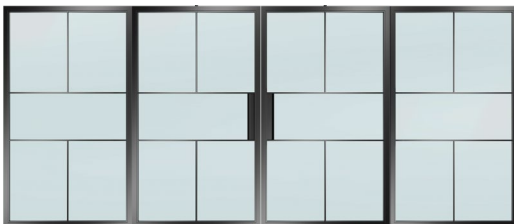
Porte pivotante à 2 vantaux avec 2 parties latérales et motif 2, parclose Slim
